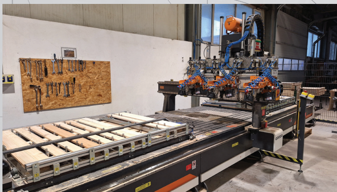
Namesto klasične rezkalne glave ima CNC stroj za zabijanje palet nameščene pnevmatske pištole.
